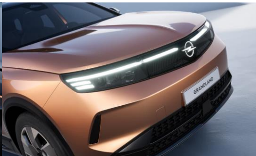
Intelli-Lux LED® svetlomety Adaptívne svetlá s 51 200 pixelmi s automatickým vypínaním jednotlivých jednotiek
